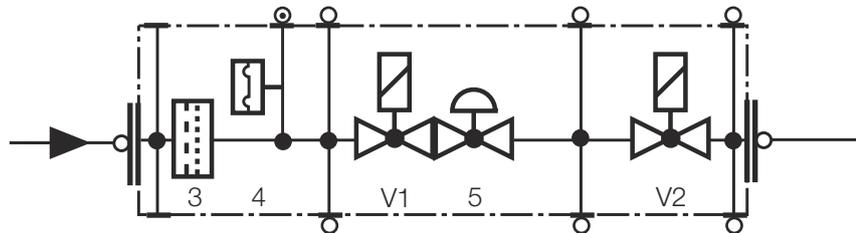
Монтаж устройства для контроля клапанов VPS 504 может быть произведен
