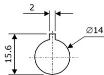
Per fissare i sensori di fiamma tipo FC7, FC8, FC9 e FC11 si consiglia di usare viti di Ø 4 mm.
