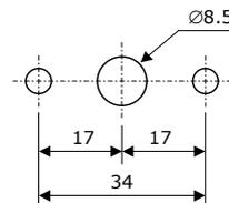
Dima di fissaggio FC13 e FC14 ( fissaggio per interferenza meccanica con la custodia della fotoresistenza )
