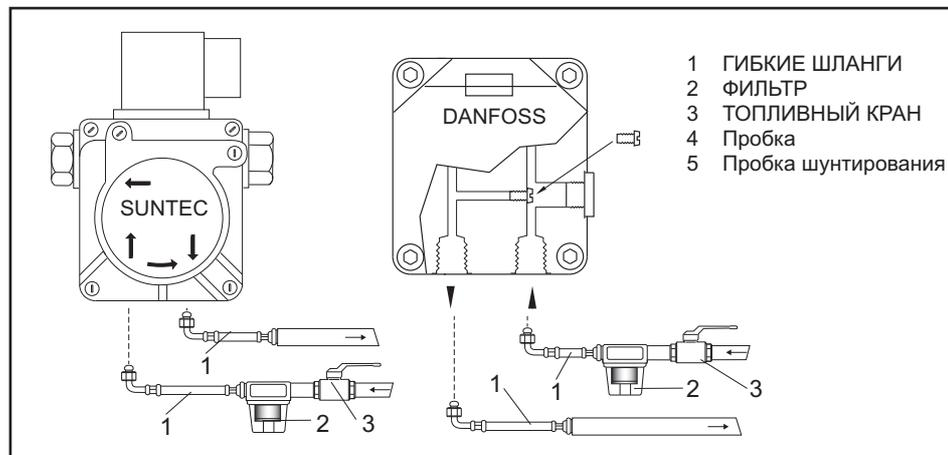
Насос, используемый в горелке газойля – это насос шестерённый самовсасывающий насос, который должен быть соединён с однотрубной системой; в систему труб аспирации вставить фильтр.
