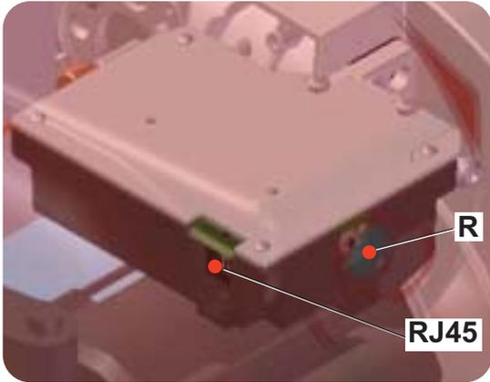
**R** - Кнопка сброса + светодиод сигнализации блокирования.
