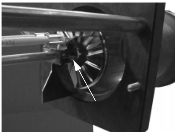
Выбранные форсунки ввинтить при помощи шестигранного ключа (SW16). Вильчатый гаечный ключ следует использовать как к контропору. Затем вплотную снова насаживается подпорный диск и затягивается до упора.
