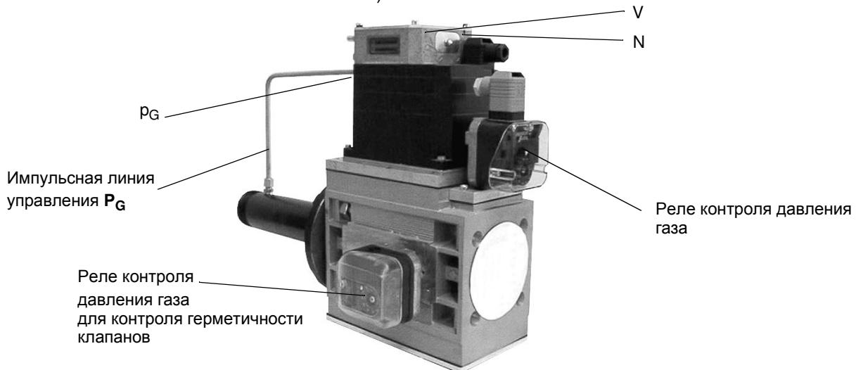
Соединительная трубка синего цвета служит как воздушная линия управления для компактного газового блока и должна пролегать в свободном изгибе. Разрежьте синюю трубку на две части. Одной половиной синей трубы соединить ниппель **P<sub>L</sub>** на компактном газовом блоке с штуцером на газовой обойме, второй половиной трубы соединить ниппель **P<sub>F</sub>** с штуцером топки котла.
