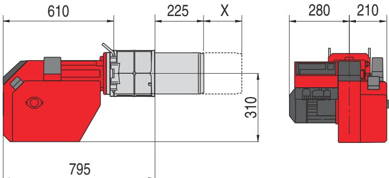
X = удлинение горелочной трубы 100 мм и 200 мм
