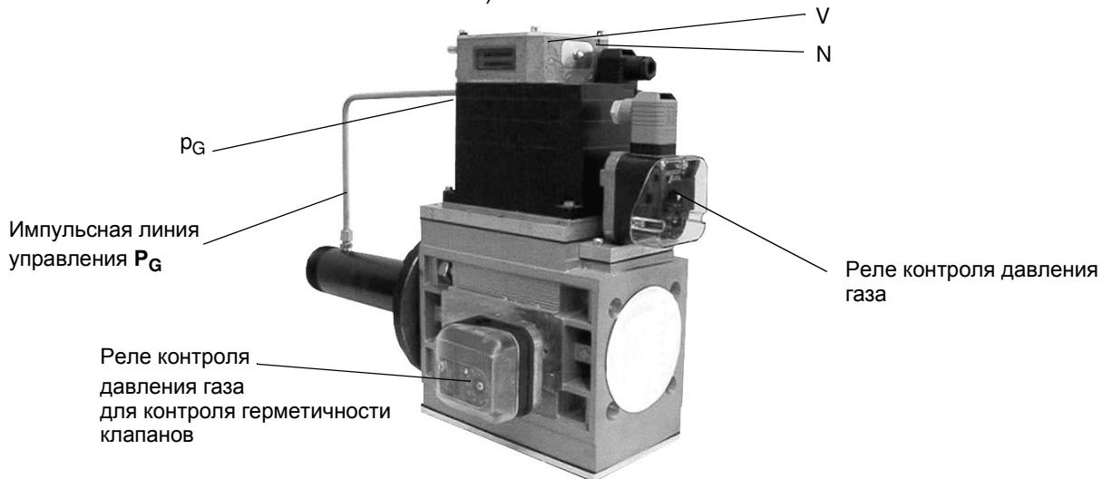
Соединительная трубка синего цвета служит как воздушная линия управления для компактного газового блока и должна пролегать в свободном изгибе. Разрежьте синюю трубку на две части. Одной половиной синей трубы соединить ниппель  $P_L$  на компактном газовом блоке с штуцером на газовой обойме, второй половиной трубы соединить ниппель  $P_F$  с штуцером топки котла.
