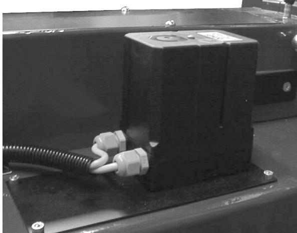
Сервопривод воздушной заслонки служит для установки воздушной заслонки у горелок с воздушным затвором. Установки задаются через электронный блок управления.
