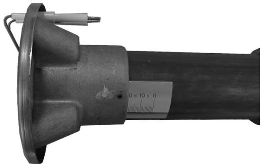
В зависимости от необходимой мощности смесительная головка устанавливается в положение согласно таблицы на странице 16.
