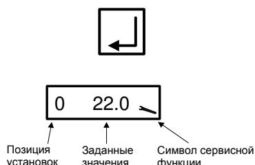
Для того чтобы открыть сервисную функцию необходимо удерживать нажатой примерно 2 сек. кнопку «Подтвердить». На дисплее высветиться точка **P0** и заданные значения воздушной заслонки сервопривода при розжиге в градусах и символ «отвёртки», обозначающий сервисную функцию.
