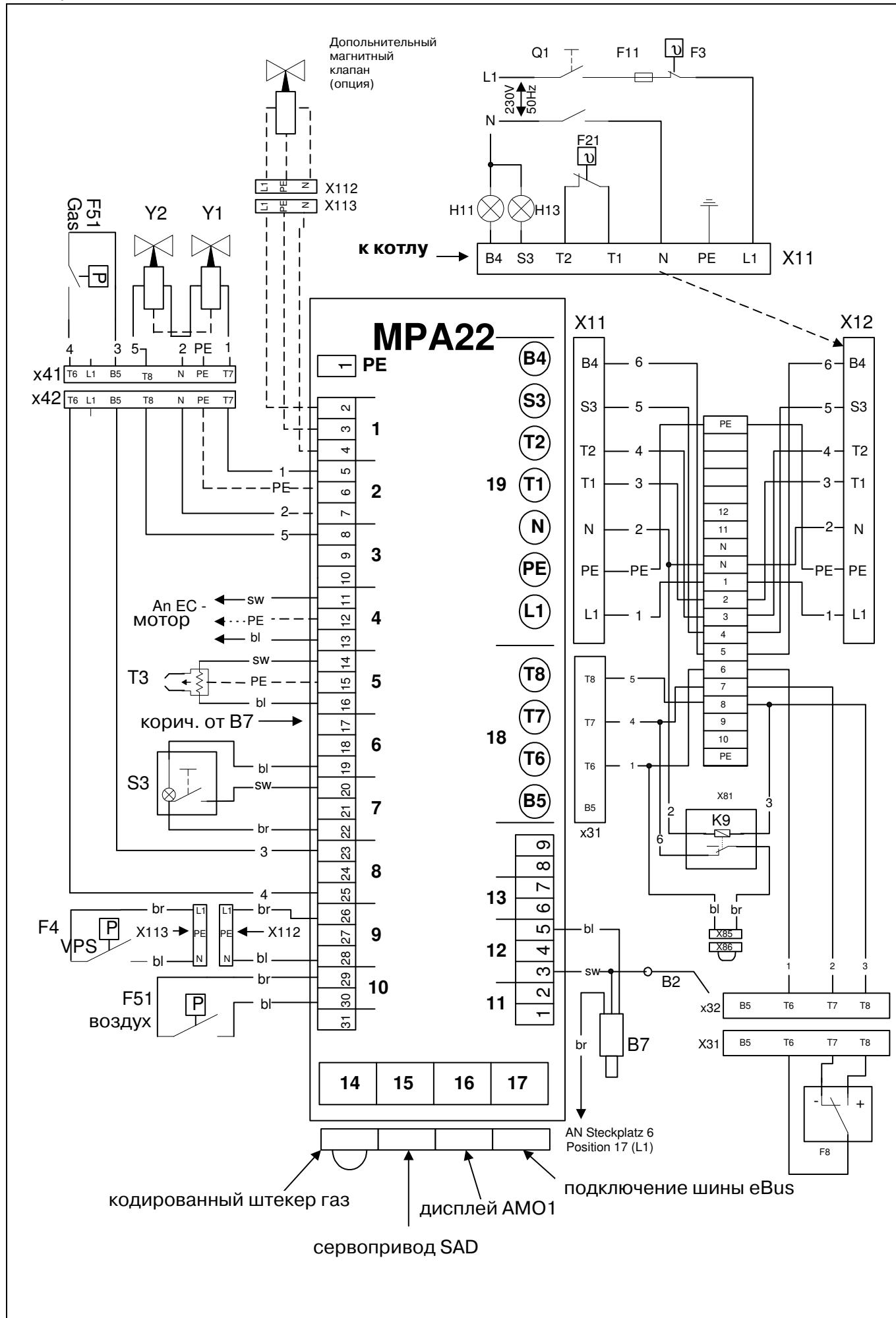
Подключение электромотора MG20-ZM-LN / MPA22
