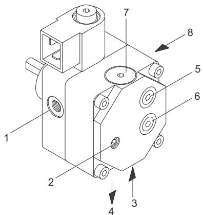
Пояснения к топливному насосу Danfoss:
