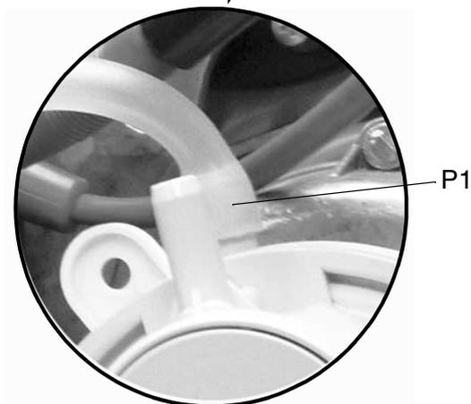
„P1“ - указывает на место присоединения силиконового шланга для измерения давления воздуха!
