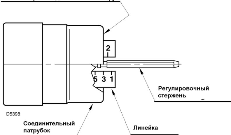
На рисунке слева головка горелки настроена на расход 3,00 галлона/час при давлении 12 бар. Риска 3 на линейке совпадает с внешней поверхностью соединительного патрубка, согласно данным, приведенным в таблице.
