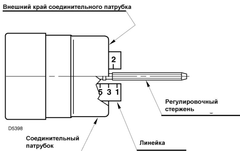
На рисунке слева головка горелки настроена на расход 3,00 галлона/час при давлении 12 бар. Риска 3 на линейке совпадает с внешней поверхностью соединительного патрубка, согласно данным, приведенным в таблице.
