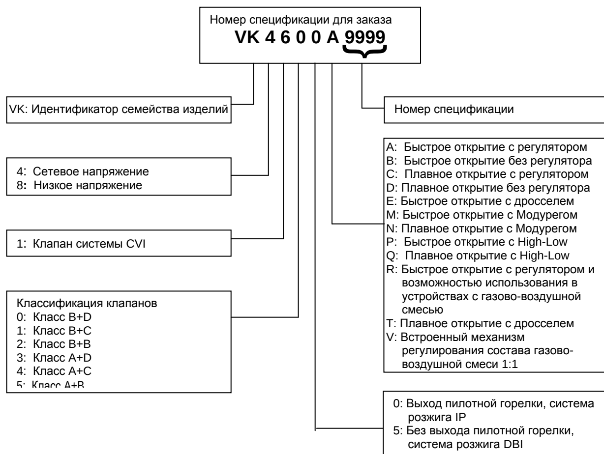
Рис. 19. Схема номера модели газовых регуляторов серии VK
