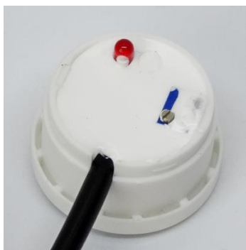
Рис.1 Регулировка чувствительности под крышкой
